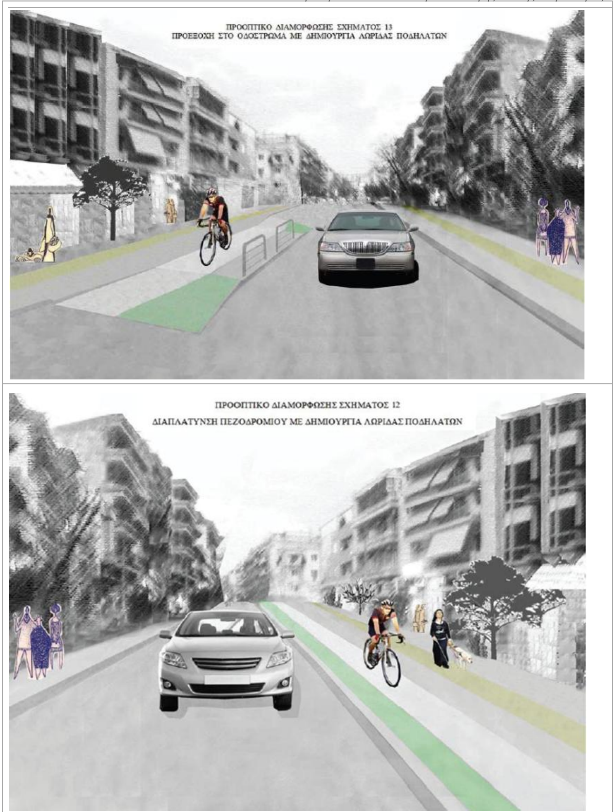
Εικόνα 9: Ενδεικτικές περιπτώσεις διαδρομών περπατησιμότητας με διαπλάτυνση πεζοδρομίου σε όλο το μήκος της οδού, προεξοχή στο οδόστρωμα ή (εφόσον το επιτρέπει η διατομή της οδού) δημιουργία λωρίδας ποδηλάτων
